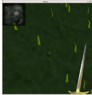
Fig. 38: Problème avec l'herbe. Le brin du milieu apparaît tout plat car les triangles sont quasiment perpendiculaires à la caméra.
