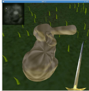
Fig. 43: Problème de texturage du lapin. Le mapping de type cylindrique pose un problème au niveau de l'axe verticale.
