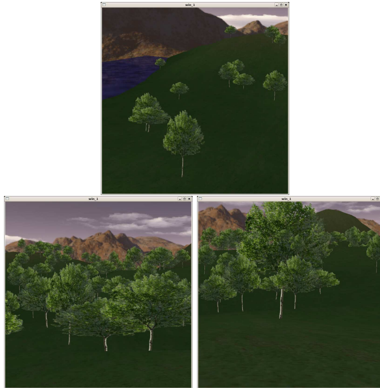
Fig. 17: Figure des quads avec la texture d'arbre après le tri. La première image montre un exemple de quelques arbres disséminés. La seconde et troisième figure montrent l'effet du tri. La seconde figure est en effet triée, et les arbres sont les uns derrière les autres même en grand nombre. Par contre, la troisième figure possède des arbres non triés, l'arbre au premier plan est alors mal affiché car les arbres situés derrière lui sont affichés devant.
