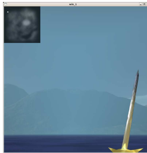
Fig. 41: Problème des coins avec l'utilisation de la sky box rectangulaire et du brouillard. Les bords sont en effet plus atténués, car ils sont situés à une distance plus grande de l'observateur.
