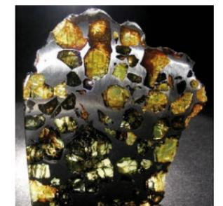
Figure 4 : Météorite (pallasite) constituée de cristaux d'olivine dans une matrice de fer-nickel métallique.
