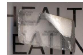
Figure 2 : Dédoublage d'une image par un cristal biréfringent.
